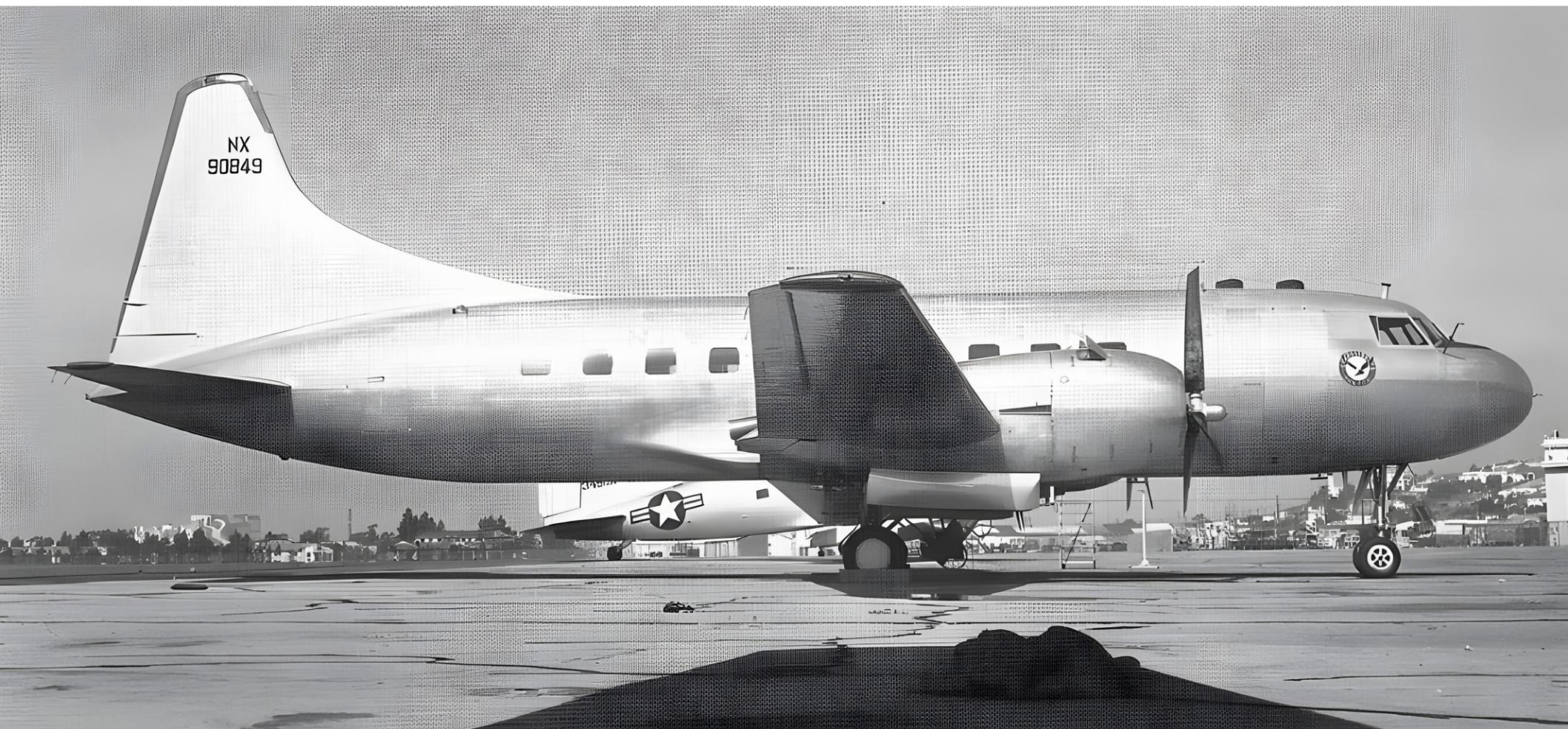
的双发活塞式短程客机，1950年首飞，1954年商飞，采用了金属半单壳结构，机身呈圆形断面，前部设有驾驶舱和乘客舱，后部设有货舱，最大起飞重量17.5吨，最大载重量2.5吨，最高巡航时速380公里，最大航程2000公里，最大升限7500米，可以搭载32名乘客或3.5吨货物，能在云底高30米的复杂天气条件下安全着陆。
